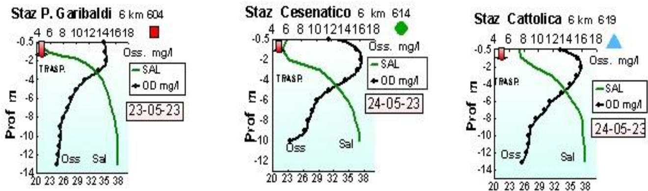
Figura 14 – Profili di salinità (psu) e ossigeno disciolto (mg/l) eseguiti con sonda multiparametrica durante i controlli del 22-23-24 Maggio nelle stazioni a 6 km prospicienti Porto Garibaldi, Cesenatico e Cattolica
